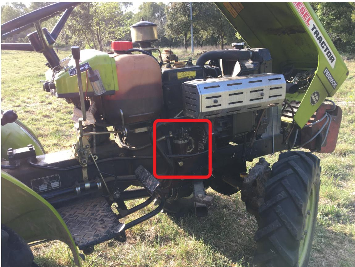
Desserrer la vis n°1 (cf photo suivante) afin de remplir le filtre de gasoil (ne pas hésiter à bien laisser couler le gasoil à l'extérieur) puis la resserrer.
